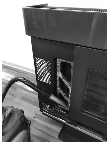
Fig. 38 - Pulizia camera fumi
