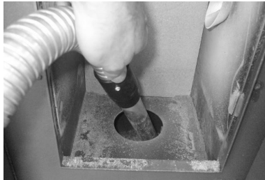
Fig. 32 - Pulizia vano braciere
